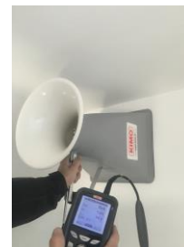
Recensement et examen des entrées d'air, des bouches de soufflage et d'extraction dans les locaux + relevé de débit de VMC
